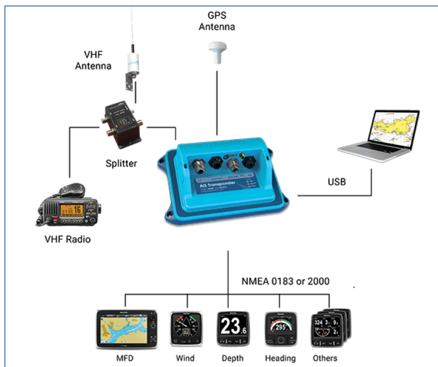
Figura 4 - Installazione completa VHF DSC & AIS Class B
